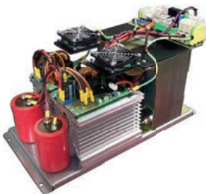
Alimentatore custom con trasformatore
