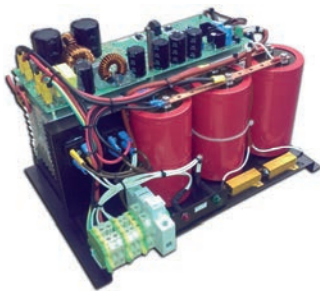
Alimentatore AC-DC Stabilizzato 30A Con protezione, segnalazione rete e carico
