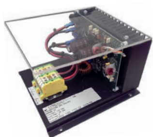
Convertitore DC-DC Ingresso 110VDC uscita 24VDC 10A
