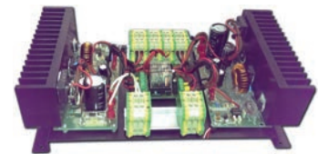
Alimentatore Doppio Canale Con due uscite per canale da 10A
