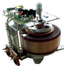
Variac monofase motorizzato con elettronica di controllo
